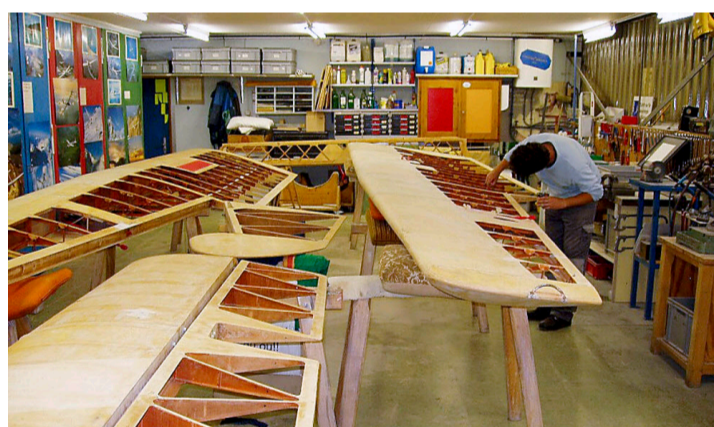
In der Werkstatt wurde die Rhönlerche wieder flugtauglich gemacht. Rund 3000 Arbeitsstunden hat die Segelfluggruppe Bern investiert.
