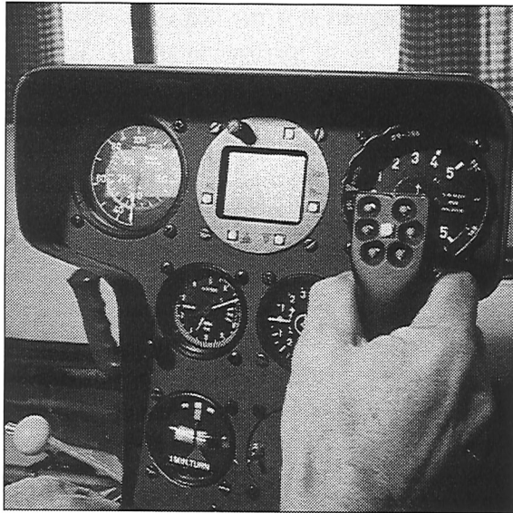
Top: die Fernbedienung am Knüppel
